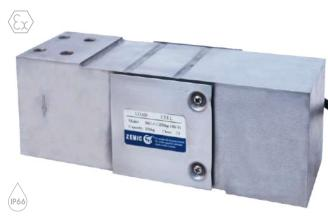
**B6G – тензометрический датчик** одноточечного типа. Одноточечный тип датчиков применяется для изготовления весов и весоизмерительных систем на одном датчике, в основном применяется при изготовлении торговых, напольных весов, а также дозирующего оборудования. Класс защиты тензодатчика **IP66**.
