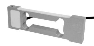
L6B – тензометрический датчик одноточечного типа. Одноточечный тип датчиков применяется для изготовления весов и весоизмерительных систем на одном датчике, в основном применяется при изготовлении торговых, напольных весов, а также дозирующего оборудования. Полимерная заливка измерительных элементов обеспечивает класс защиты тензодатчика IP65.
