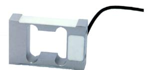
**L6H5 – тензометрический датчик** одноточечного типа. Одноточечный тип датчиков применяется для изготовления весов и весоизмерительных систем на одном датчике, в основном применяется при изготовлении торговых, напольных весов, а также дозирующего оборудования. Полимерная заливка измерительных элементов обеспечивает класс защиты тензодатчика **IP65**.
