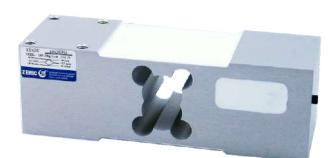
L6W - тензометрический датчик одноточечного типа. Одноточечный тип датчиков применяется для изготовления весов и весоизмерительных систем на одном датчике, в основном применяется при изготовлении торговых, напольных весов, а также дозирующего оборудования. Полимерная заливка измерительных элементов обеспечивает класс защиты тензодатчика ІР65.
